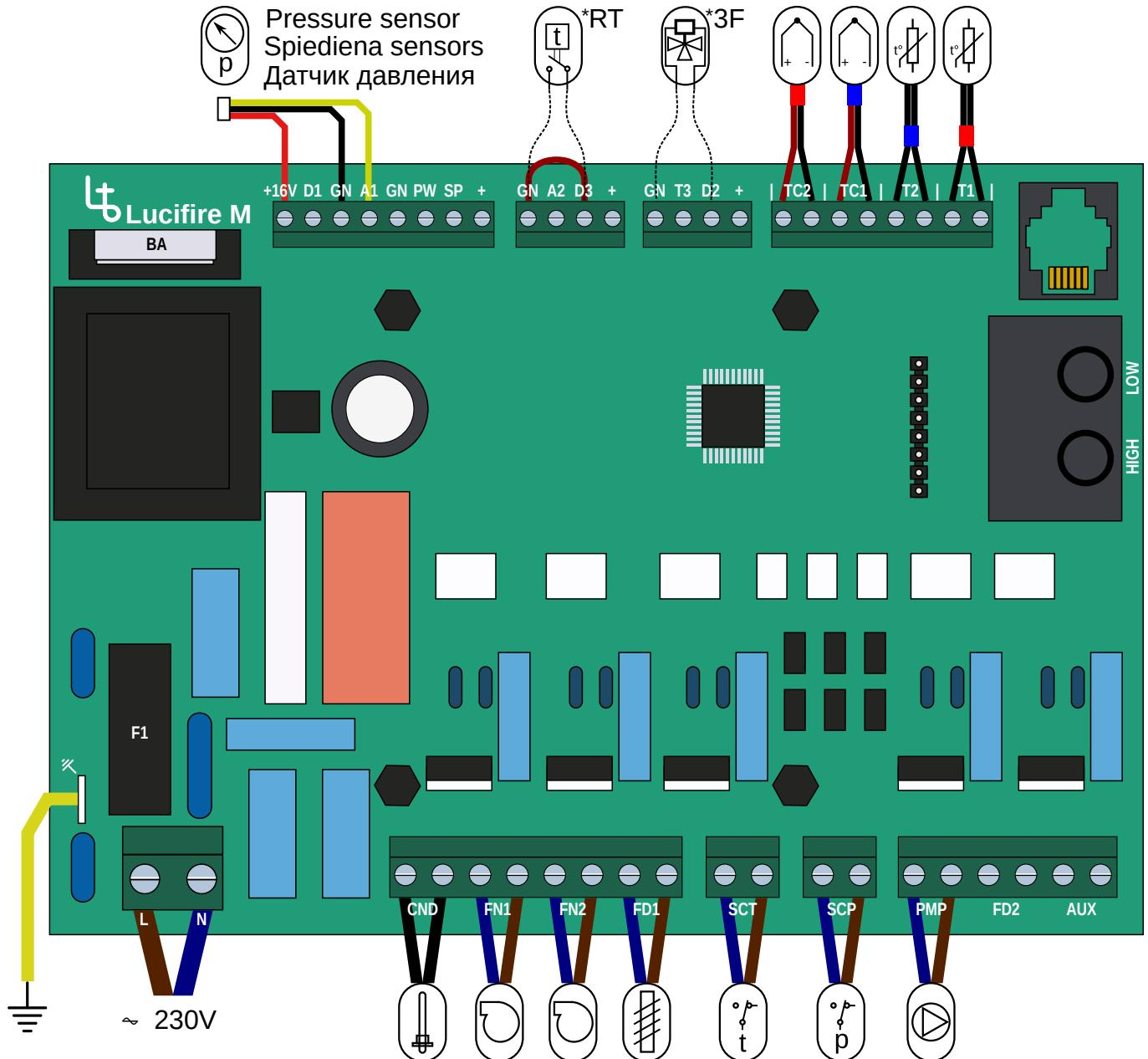
TC1 - firebox thermocouple | degkameras termopāris | термопара в топке
